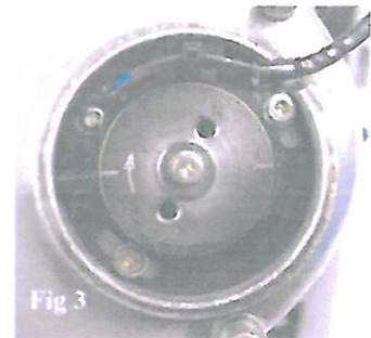
Fase 11: Utilizzare un disco goniometrico e portare il pistone al punto morto superiore al massimo anticipo per il modello specifico di moto (per esempio 28° prima del PMS per il 450 cc e 38° prima del PMS per il 250cc ma controllare il setting giusto. Vedere la figura 3 e con il pistone trattenuto nella giusta posizione allineare la linea sul pick up alla linea sul rotore.
